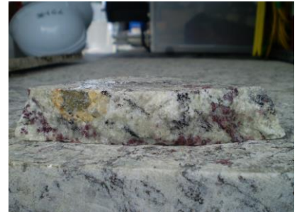
4. 乾いた浸透層からもサビ発生
